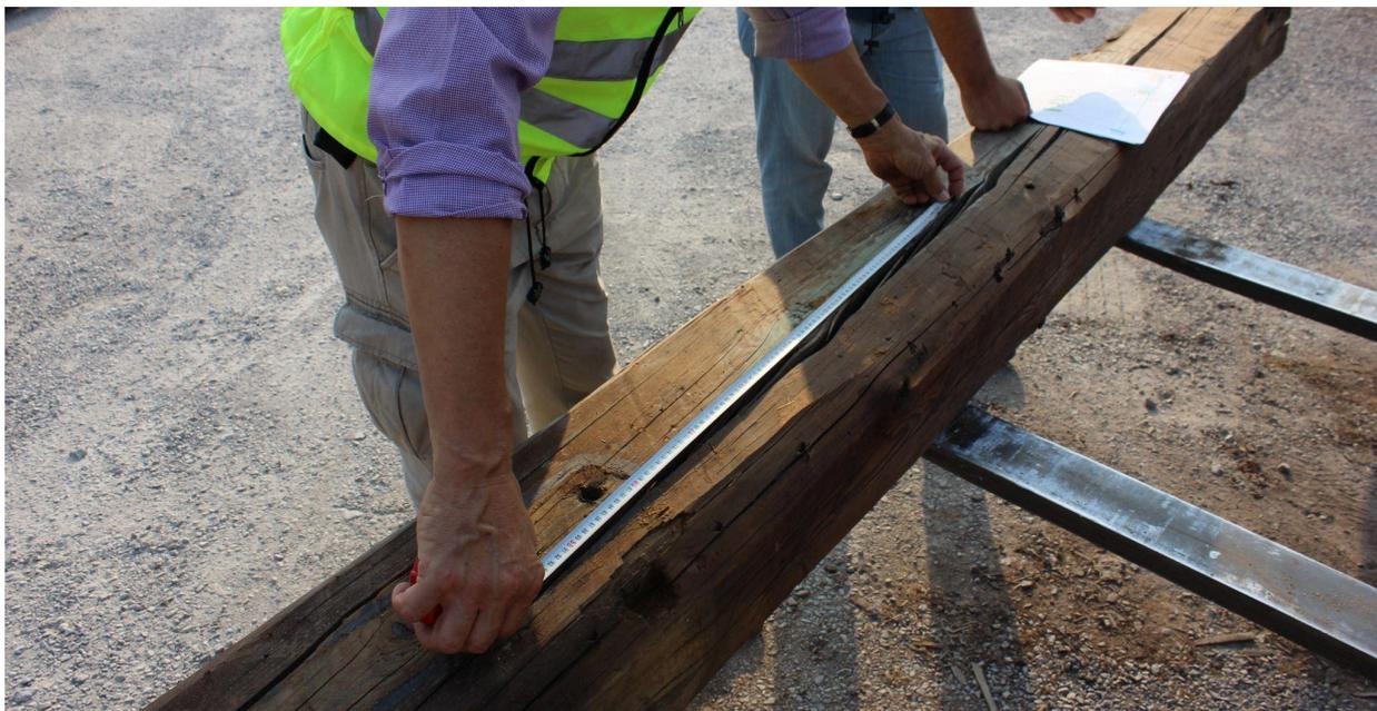
Classificazione travatura tramite indagini penetrometriche
